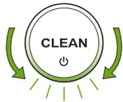
Cuando el robot detecte que su recipiente de residuos debe vaciarse, la luz indicadora se encenderá con un barrido rojo hacia la parte posterior.
